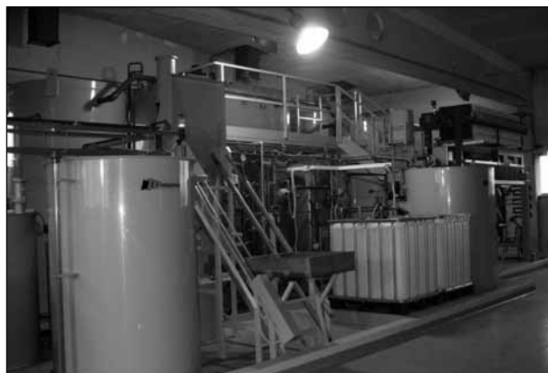
Ryc. 7. Automatyczny neutralizator w PZL Wrocław- jako część Centrum Pokryć Galwanicznych.
