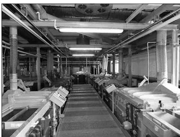
Ryc. 6. Linia automatyczna do cynkowania alkalicznego dla PIMET w Piastowie.
